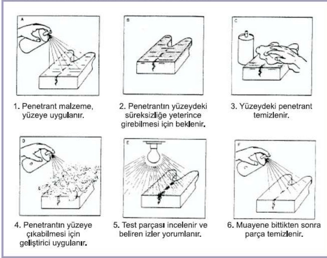
Şekil 3. Sıvı Penetrant ile Muayenenin Temel Aşamaları
